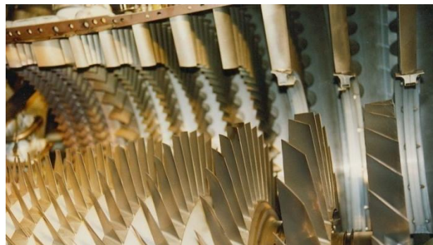
en van een schoepenrad in een stoomturbine.
