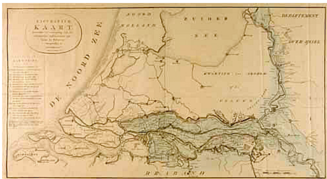
Figurative kaart dienende ter aanwijzing van de voornaamste dijkbreuken enz, langs de rivieren; voorgevallen in Louwemaand 1809 (in blauw de overstromde gebieden)
