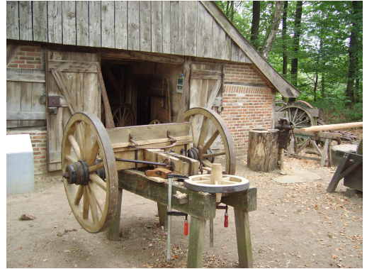
Wieldraaierij. Hier werden houten wagenwielen gemaakt en van een ijzeren band voorzien. (Openluchtmuseum Arnhem).
